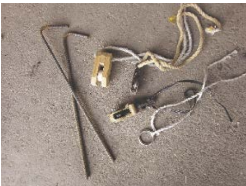
写真 32 杭 各滑車 綱を通すためのリング
